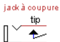
Figure 10. Avec un câble dans la prise, le "point milieu" du jack ne touche plus le point "tip"
