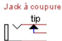
Figure 9. Schéma d'une prise jack à coupure
