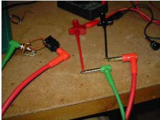
Figure 15. Les tip doivent donner 0 ohm, ils sont reliés électriquement
